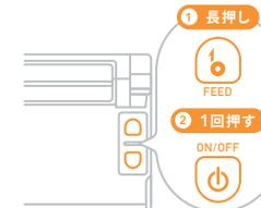
FEEDボタンを押しながら、ON/OFFボタンを押すと現在の設定内容が印刷されます。
