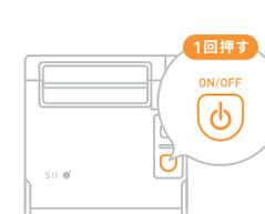
ON/OFFボタンを1回押すと、現在の設定内容が印刷され、機能設定モードを終了します。
