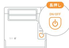
正面にあるON/OFFボタンを、長押しして電源をオフにします。
