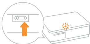
本体側面の電源をオンにすると、上部のランプが青色に点灯し、ペアリングの準備が整います。
