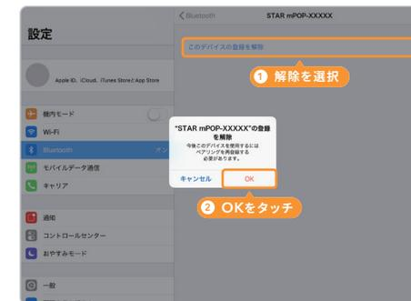
「このデバイスの登録を解除」をタッチし、表示されるダイアログの「OK」をタッチすると、ペアリングが解除されます。
