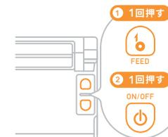
FEEDボタンを1回押し、ON/OFFボタンを1回押すとプリンターの初期化が完了します。
