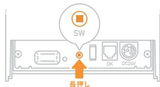
本体背面のペアリングスイッチを5秒以上長押しすると、左横のランプが青く点滅し、ペアリングの準備が整います。
